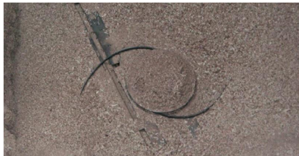
Slika Pogreška! U dokumentu nema teksta navedenog stila..63 Pražnjenje opružnom jezgrom (izvor: Herz).
