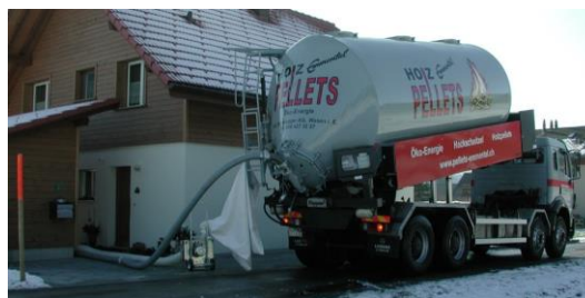
Slika Pogreška! U dokumentu nema teksta navedenog stila..5520 Isporuka peleta s usisnom cijevi i spremnikom za prašinu (izvor: Holzenergie Schweiz)
