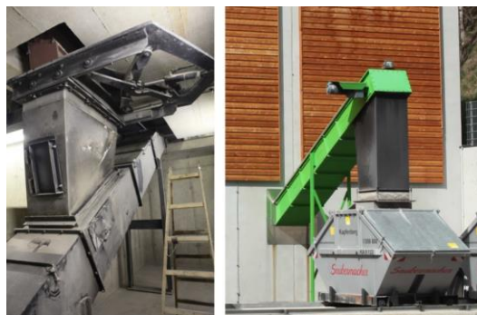
Slika Pogreška! U dokumentu nema teksta navedenog stila..7641 Mehanički transporter za uklanjanje pepela: s lančanim strugač transporterom (izvor: AEE INTEC).
