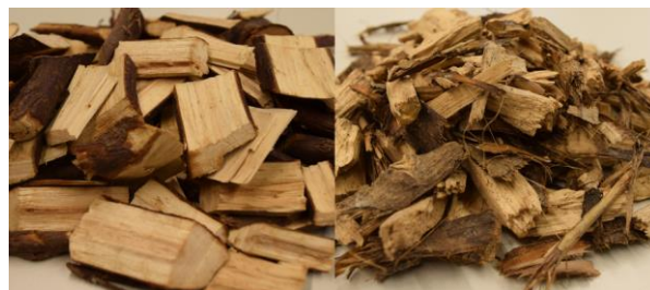
Slika Pogreška! U dokumentu nema teksta navedenog stila.. 10 Različitosti između drvene sječke (izrezane oštrim alatima, lijevo) i isjeckanog drva (sjeckanog tupim alatom, desno).
