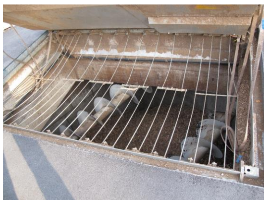
Slika Pogreška! U dokumentu nema teksta navedenog stila..46 Vijci za punjenje (izvor: Holzenergie Schweiz).
