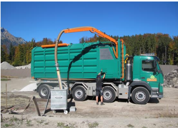
Slika Pogreška! U dokumentu nema teksta navedenog stila..158 Transportno vozilo s ugrađenim sustavom za vađenje pepela (izvor: Holzenergie Schweiz).
