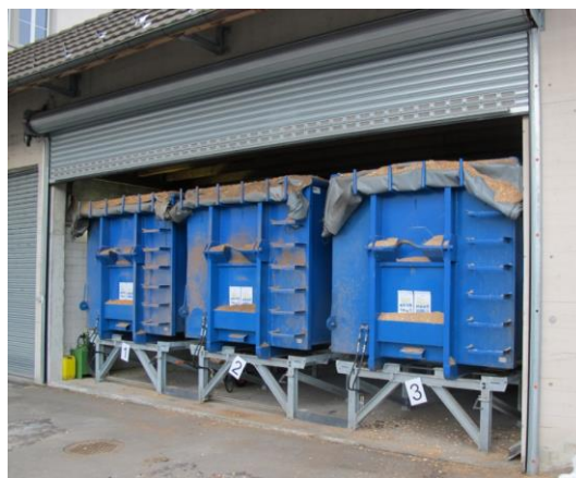
Slika Pogreška! U dokumentu nema teksta navedenog stila..37 Mobilni spremnici od drvene sječke s pražnjenjem kao zamjena za silose (izvor: Holzenergie Schweiz).
