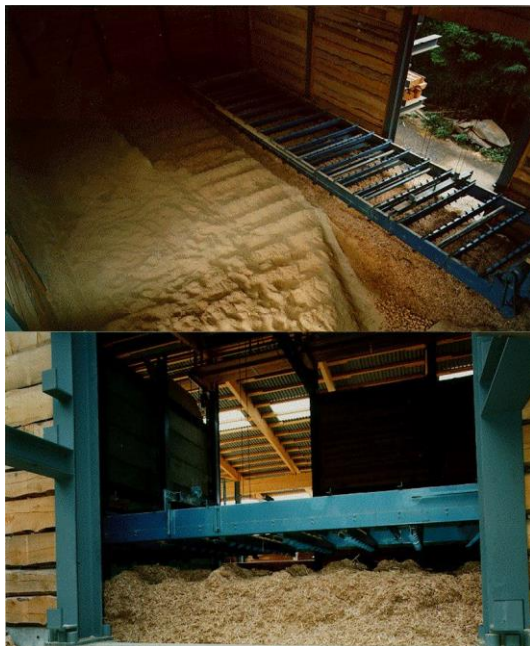
Slika Pogreška! U dokumentu nema teksta navedenog stila..51 Sustav za utovar i istovar s vodoravno i okomito pomičnim strugajućim lančanim transporterom [68].
