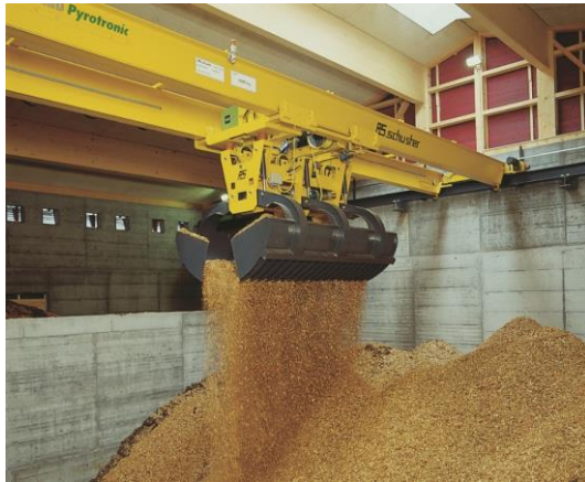
Slika Pogreška! U dokumentu nema teksta navedenog stila..5015 Potpuni automatski sustav dizalica s koritom za istovar i dnevnim silosom (izvor: Schmid energetska rješenja).
