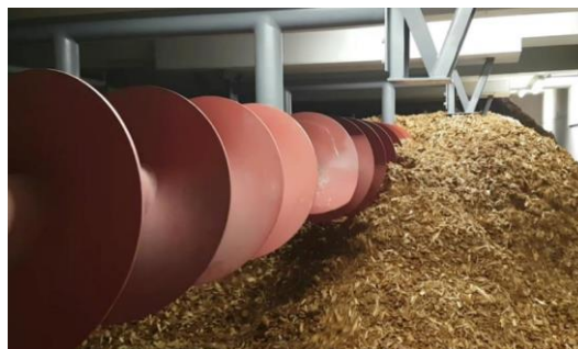
Slika Pogreška! U dokumentu nema teksta navedenog stila..47 Silo distributer (izvor: Schmid energetska rješenja).
