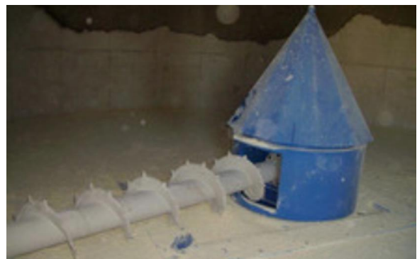
Figure 6.26 Milling screw (source: JPA Fördertechnik).
