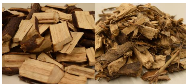
Rysunek 4.4. Errore. Nel documento non esiste testo dello stile specificato..10 Rozróżnienie między zrębkami (ciętymi ostrymi narzędziami, po lewej) i rozdrobnionym drewnem (rąbanym narzędziami, po prawej).
