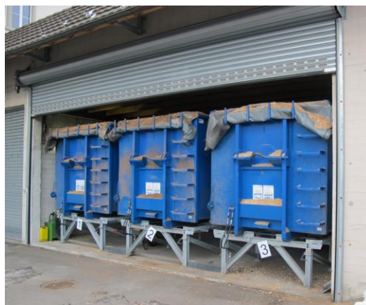
Rysunek 6.2 Mobilne pojemniki na zrębki drzewne z rozładunkiem jako substytutem silosów (źródło: Holzenergie Schweiz).
